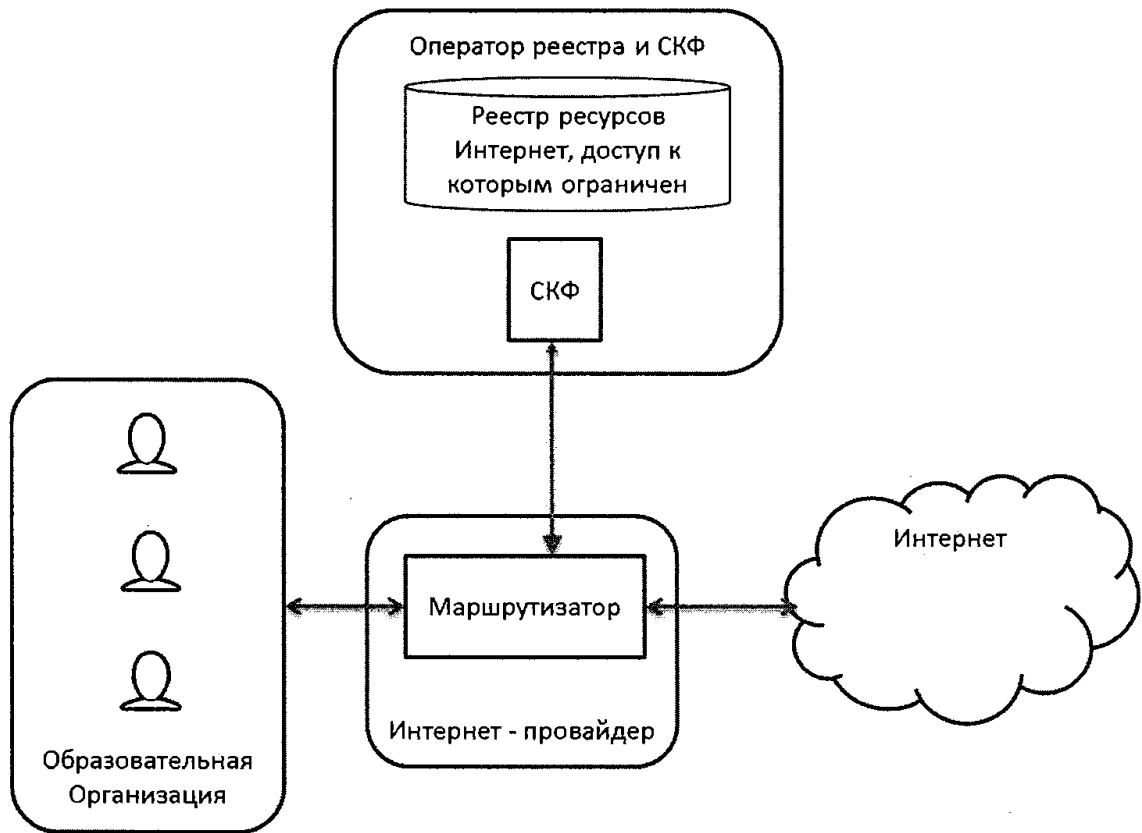
Рисунок 5. Схема работы контент-фильтрации при едином решении
